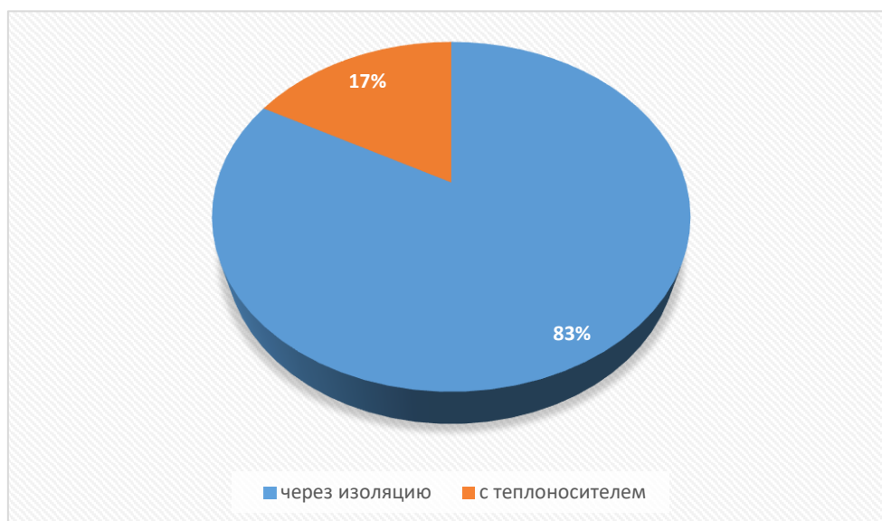
Рисунок 3-5 – Потери тепловой энергии в тепловых сетях
