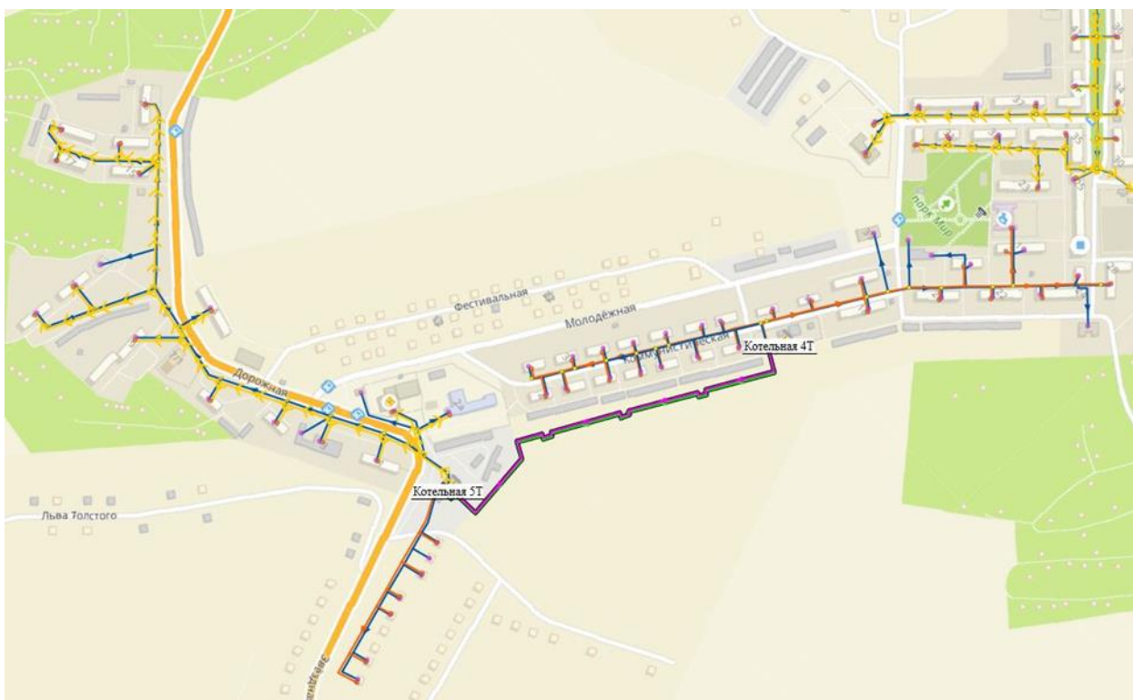
Рисунок 6.2 Трассировка рекомендуемой перемычки между источниками Котельной 4Т и Котельной 5Т
