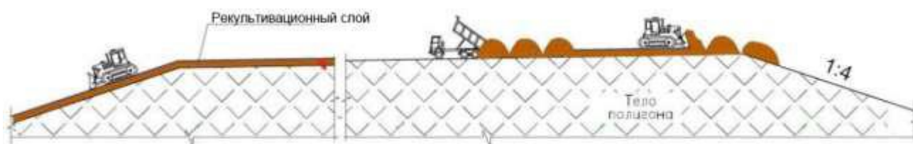
Рис. 2 – Условная схема формирования выравнивающего слоя
