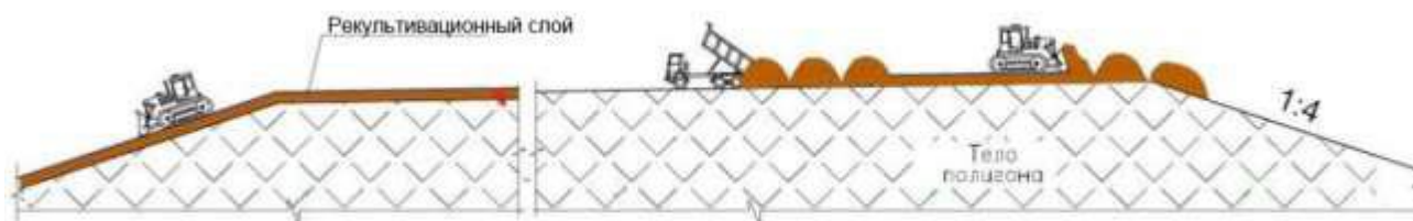
Рис. 2 – Условная схема формирования выравнивающего слоя
